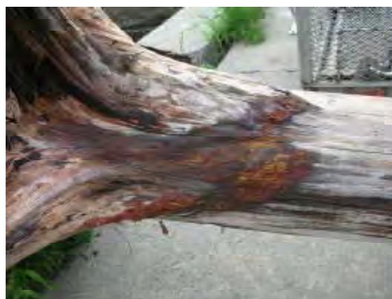
写真8 船底塗料痕
